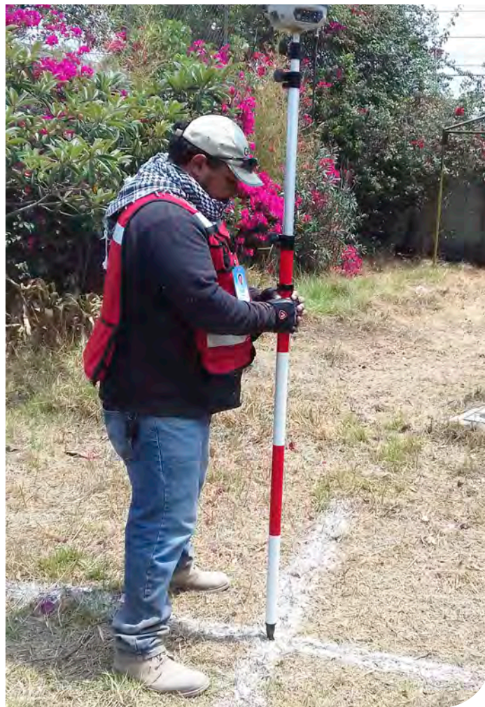
Levantamiento de coordenadas en un sitio de disposición final, con un equipo que receptiona información espacial proveniente de satélites. Foto: Constantino Gutiérrez Palacios.
