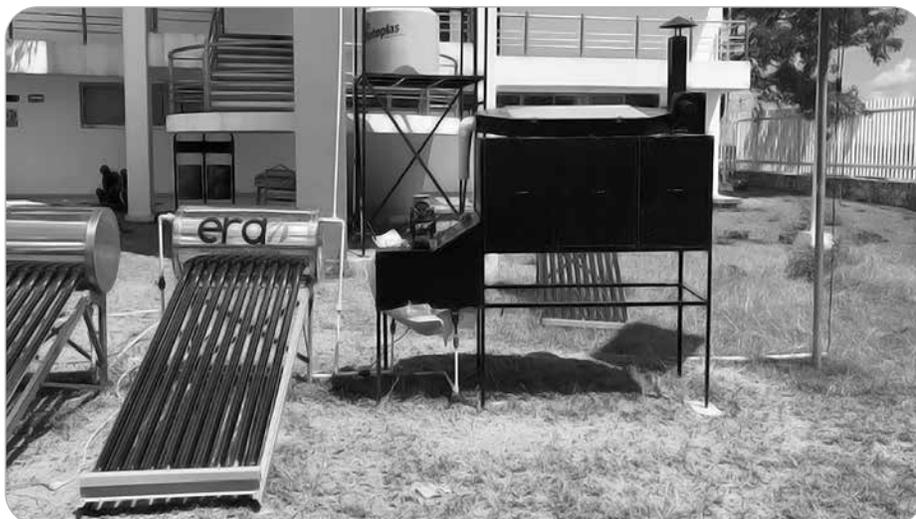
Figura 2. Secador solar indirecto con combinación de tecnologías solares en el Laboratorio de Secado Solar de la Facultad de Ingeniería de la Universidad Autónoma de Campeche.
