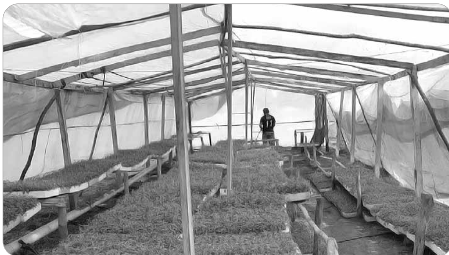
Figura 3. Secador solar tipo invernadero (de stevia) en Nohacal, Campeche. Instalado por la Facultad de Ingeniería de la Universidad Autónoma de Campeche en colaboración con Firco.
